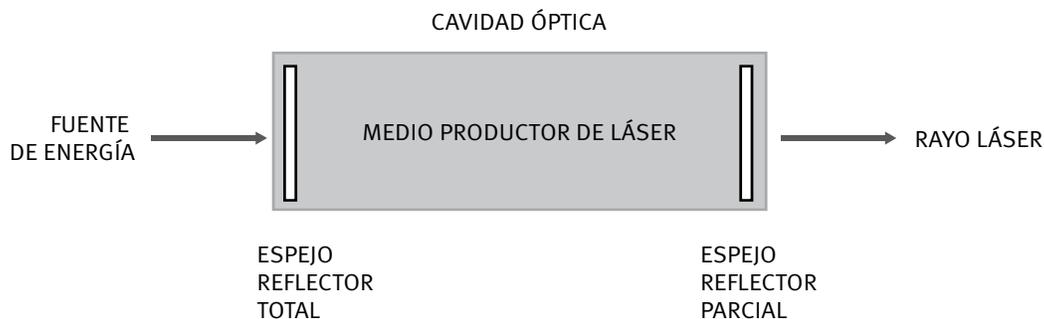
**FIGURA 1.** Representación esquemática del funcionamiento del láser.
